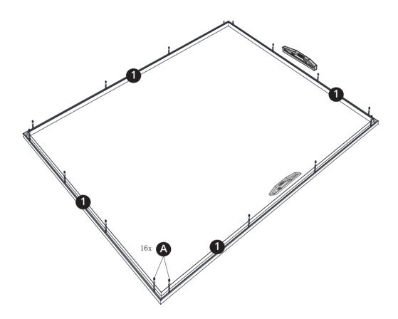
**RU:** Установите алюминиевые нижние рамы в соответствии с размерами и расположением, показанными на схеме, затем закрепите их пластиковыми распорными болтами. Пожалуйста, убедитесь в том, что нижние рамы выровнены.
