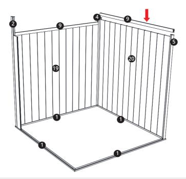
**RU:** Установите алюминиевую колонну (правую и заднюю) на место, затем вставьте алюминиевую H-образную балку (заднюю) в колонну.
