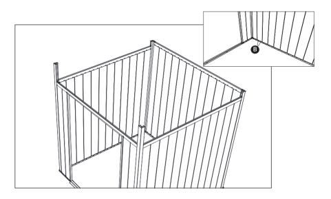
**RU:** После регулировки, пожалуйста, закрепите стену из досок ДПК, алюминиевую нижнюю раму и алюминиевую H-образную балку винтами, для соединения каждой стены и балок из досок ДПК требуется два винта.
