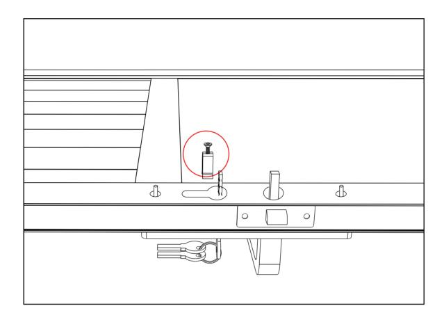
**RU:** Закрепите цилиндр замка на двери с помощью крепежных зажимов и винтов.
