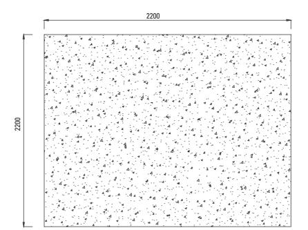
**RU:** Сарай должен быть установлен на твердом грунте, например на бетонном фундаменте. Поверхность грунта должна быть ровной, а размер должен соответствовать размерам чертежа.
