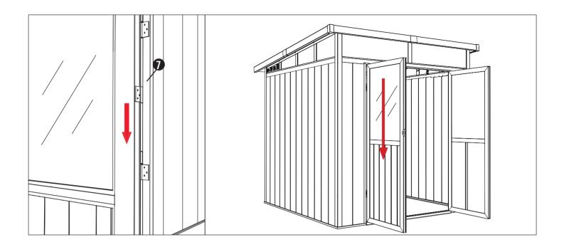
**RU:** Теперь установите и закрепите двойную дверь с помощью петель. Проверьте, как открывается/ закрывается дверь, и при необходимости отрегулируйте положение. Как только вы выберете удобное положение, прикрутите дверную раму к задней части стеновой панели.
