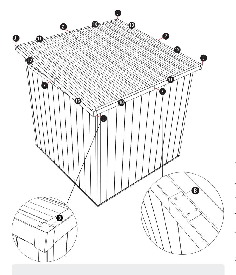
**RU:** После соединения установите U-образный профиль вокруг панели крыши. Закрепите алюминиевую кромку (деталь Z) на стыках U-образного профиля с помощью винтов, входящих в комплект поставки В. Установите пластиковые колпачки (деталь J) на 4 углах крыши с помощью винтов, входящих в комплект поставки В.
