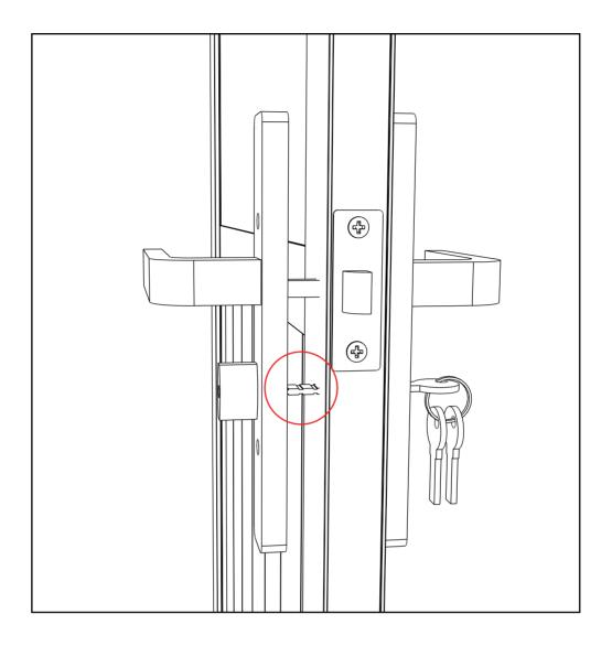
**RU:** Установите дверную ручку и цилиндр замка в соответствующее положение, как показано на схеме. При необходимости измените длину язычка замка.
