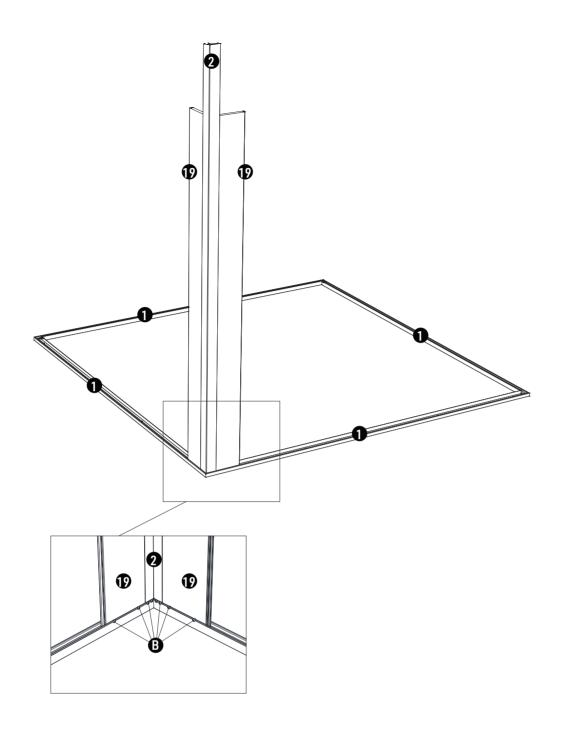
**RU:** Установите сарай лицевой стороной, вставьте колонну (левую и переднюю) и планку из ДПК в паз алюминиевых нижних рам, затем закрепите колонну и планки шурупами. Для выполнения этого шага требуются два человека, один из которых должен удерживать колонну, чтобы избежать поломки, вызванной наклоном.
