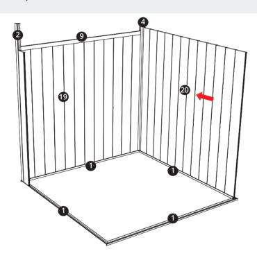
**RU:** Вставьте алюминиевую H-образную балку (слева/справа) в колонну, затем одну за другой установите на это место дощатую перегородку из ДПК.
