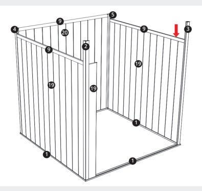
**RU:** Установите алюминиевую колонну (справа и спереди) на место, затем вставьте алюминиевую H-образную балку (слева/справа) в колонну.
