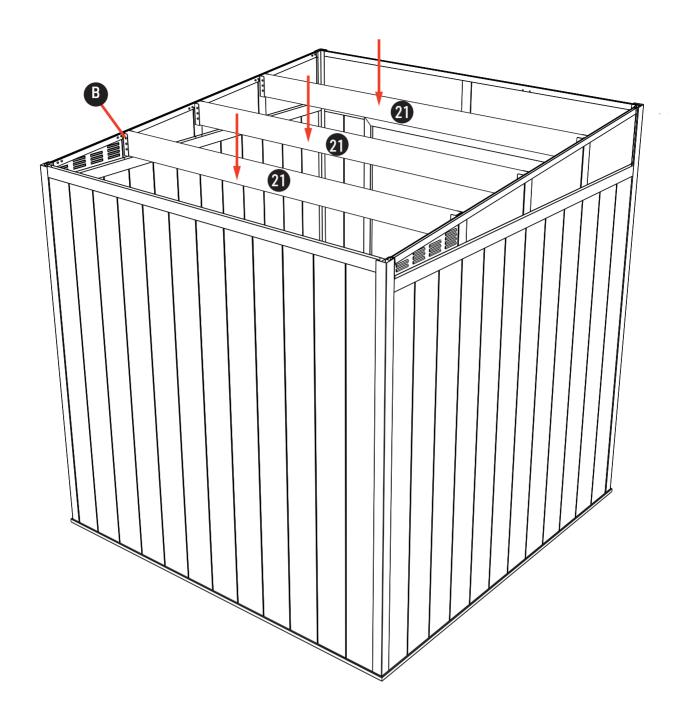
**RU:** Вставьте 3 балки крыши в соединители. Закрепите балки крыши на соединителях с помощью винтов части В.
