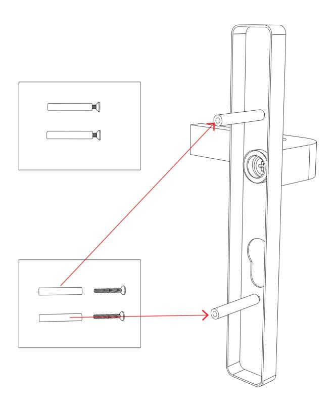
**RU:** Выньте винт из маленького разъема. Установите разъемы так, как показано на схеме, затем закрепите их винтами.
