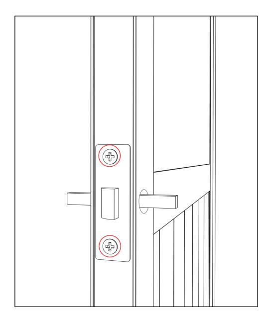
**RU:** Закрепите корпус замка, затем установите металлический угольник.
