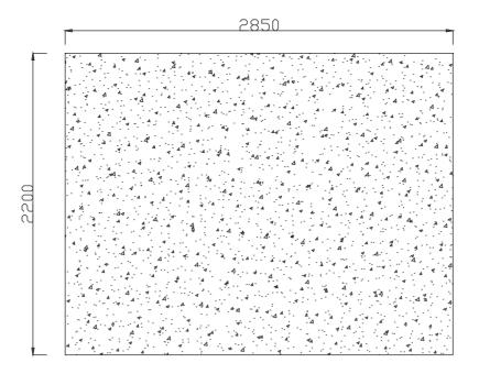
**RU:** Сарай должен быть установлен на твердом грунте, например на бетонном фундаменте. Поверхность грунта должна быть ровной, а размер должен соответствовать размерам чертежа.
