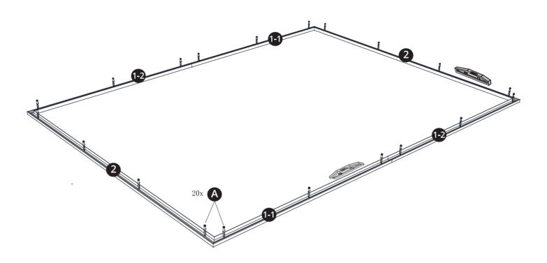
**RU:** Установите алюминиевые нижние рамы в соответствии с размерами и расположением, показанными на схеме, затем закрепите их пластиковыми распорными болтами.Пожалуйста, убедитесь в том, что нижние рамы выровнены.
