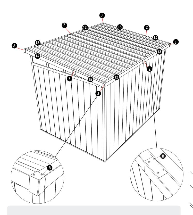
**RU:** После соединения установите U-образный профиль вокруг панели крыши. Закрепите алюминиевую кромку (деталь Z) на стыках U-образного профиля с помощью винтов, входящих в комплект поставки В.Установите пластиковые колпачки (деталь J) на 4 углах крыши с помощью винтов, входящих в комплект поставки В.
