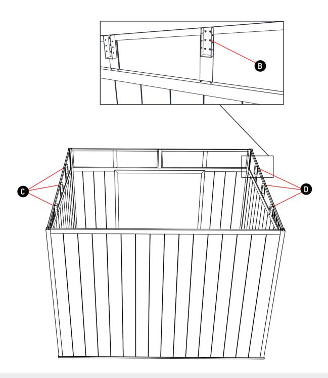
**RU:** Установите 6 разъемов на алюминиевую раму акрилового окна.Пожалуйста, обратите внимание, что разъемы расположены в левом и правом направлениях. Закрепите разъемы на алюминиевой раме с помощью винтов части В.
