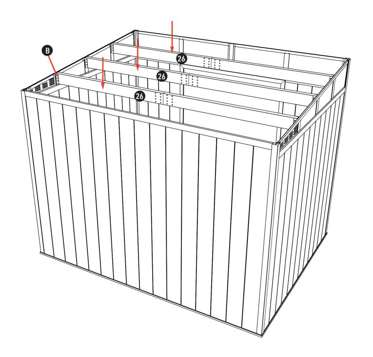
**RU:** Вставьте 3 балки крыши в соединители. Закрепите балки крыши на соединителях с помощью винтов части В.
