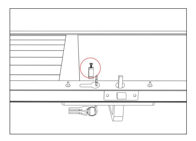
**RU:** Закрепите цилиндр замка на двери с помощью крепежных зажимов и винтов.
