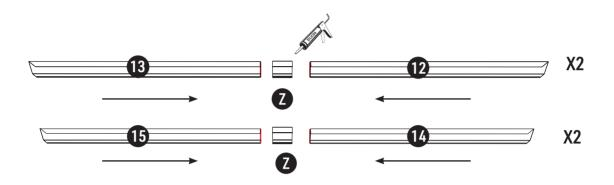
**RU:** Соедините короткий U-образный профиль с помощью герметика.
