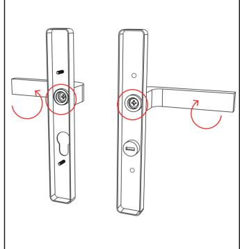
**RU:** Ослабьте винты на задней стороне ручки. Установите ручку в подходящее положение, затем снова закрепите винты. Повторите те же действия для другой дверной ручки.
