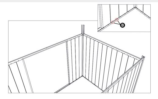
**RU:** После регулировки, пожалуйста, закрепите стену из досок ДПК, алюминиевую нижнюю раму и алюминиевую H-образную балку винтами, для соединения каждой стены и балок из досок ДПК требуется два винта.
