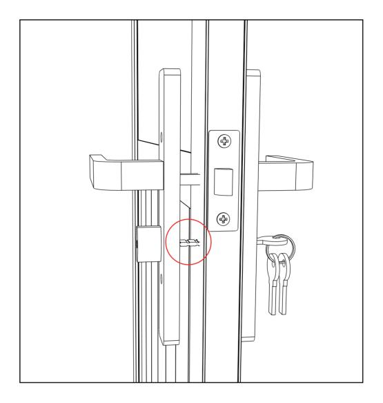
**RU:** Установите дверную ручку и цилиндр замка в соответствующее положение, как на схеме. При необходимости измените длину язычка замка.
