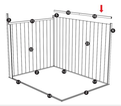
**RU:** Установите алюминиевую колонну (правую и заднюю) на место, затем вставьте алюминиевую H-образную балку (заднюю) в колонну.
