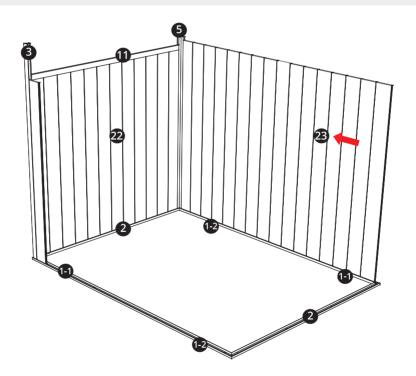
**RU:** Вставьте алюминиевую H-образную балку (слева/справа) в колонну, затем одну за другой установите на это место дощатую перегородку из ДПК.
