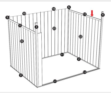
**RU:** Установите алюминиевую колонну (справа и спереди) на место, затем вставьте алюминиевую H-образную балку (слева/справа) в колонну.
