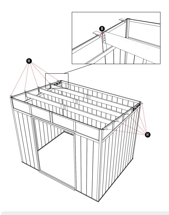
**RU:** Установите 10 кронштейнов, как показано на схеме. Закрепите кронштейны с помощью винтов части В.
