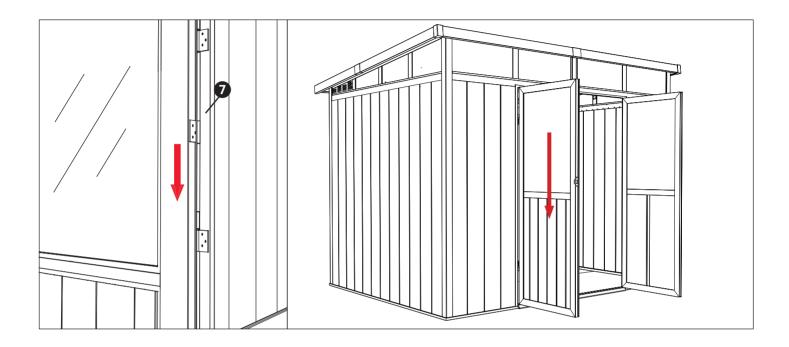
**RU:** Теперь установите и закрепите двойную дверь с помощью петель. Проверьте, как открывается/ закрывается дверь, и при необходимости отрегулируйте положение. Как только вы выберете удобное положение, прикрутите дверную раму к задней части стеновой панели.
