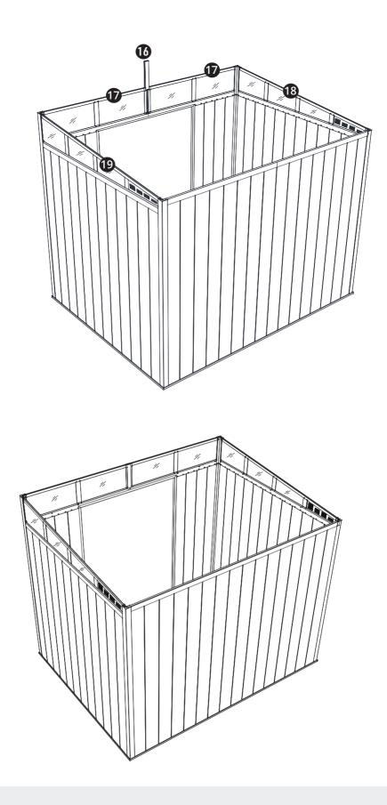
**RU:** Установите окно на место. Обратите внимание на разные стороны окна, сторона с заклепками должна быть обращена внутрь.Закрепите окно колоннами и H-образными балками с помощью шурупов.
