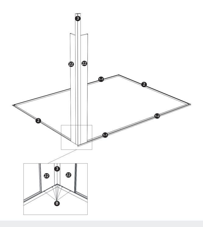
**RU:** Установите сарай лицевой стороной, вставьте колонну (левую и переднюю) и планку из ДПК в паз алюминиевых нижних рам, затем закрепите колонну и планки шурупами. Для выполнения этого шага требуются два человека, один из которых должен удерживать колонну, чтобы избежать поломки, вызванной наклоном.
